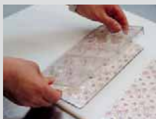
Posare il foglio con la parte trasferibile verso l'alto e chiudere lo stampo. - Put the sheet with the transfer part facing upwards and close the mould.
